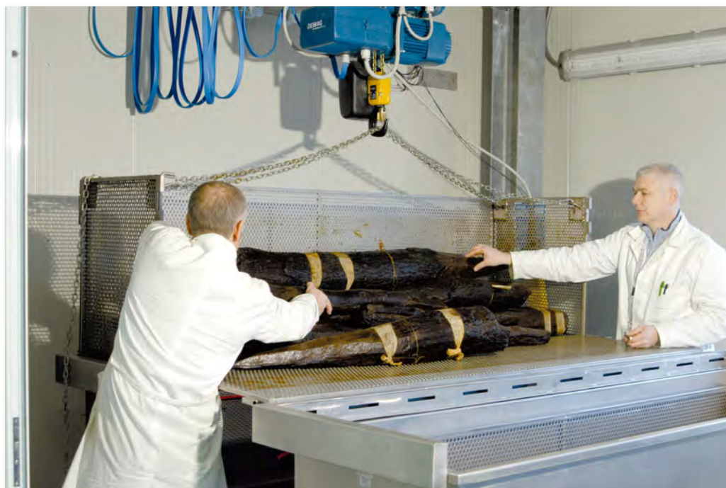
Figura 1 Fase del trattamento per saturazione dei campioni di legno
